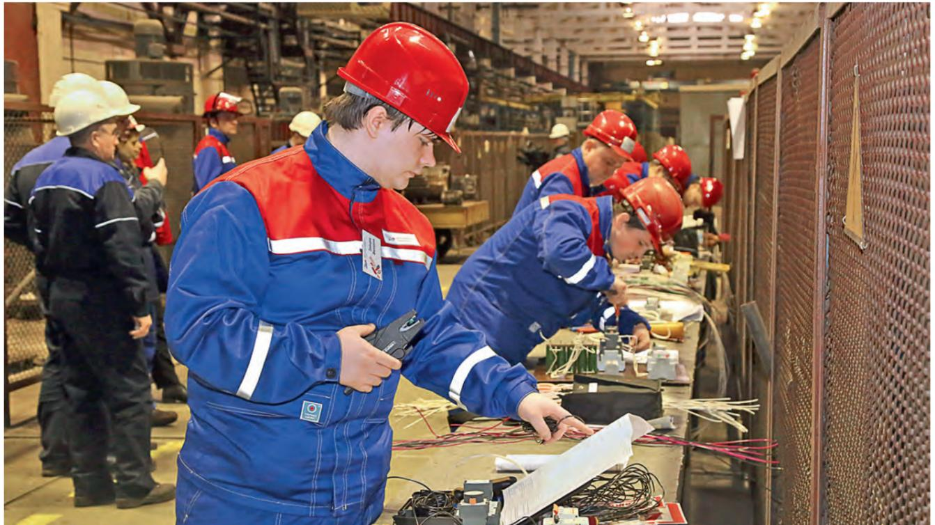
Задание — выполнить сборку испытательного стенда для включения электродвигателя постоянного тока.
