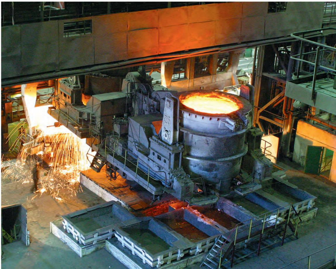
На стендах старого типа расход газа составляет 250 кубометров в час, и разогрев ковша длится 13 часов, на новом оборудовании эти показатели значительно ниже: расход газа — 100 кубометров в час, а ковш разогревается всего за пять-шесть часов.
