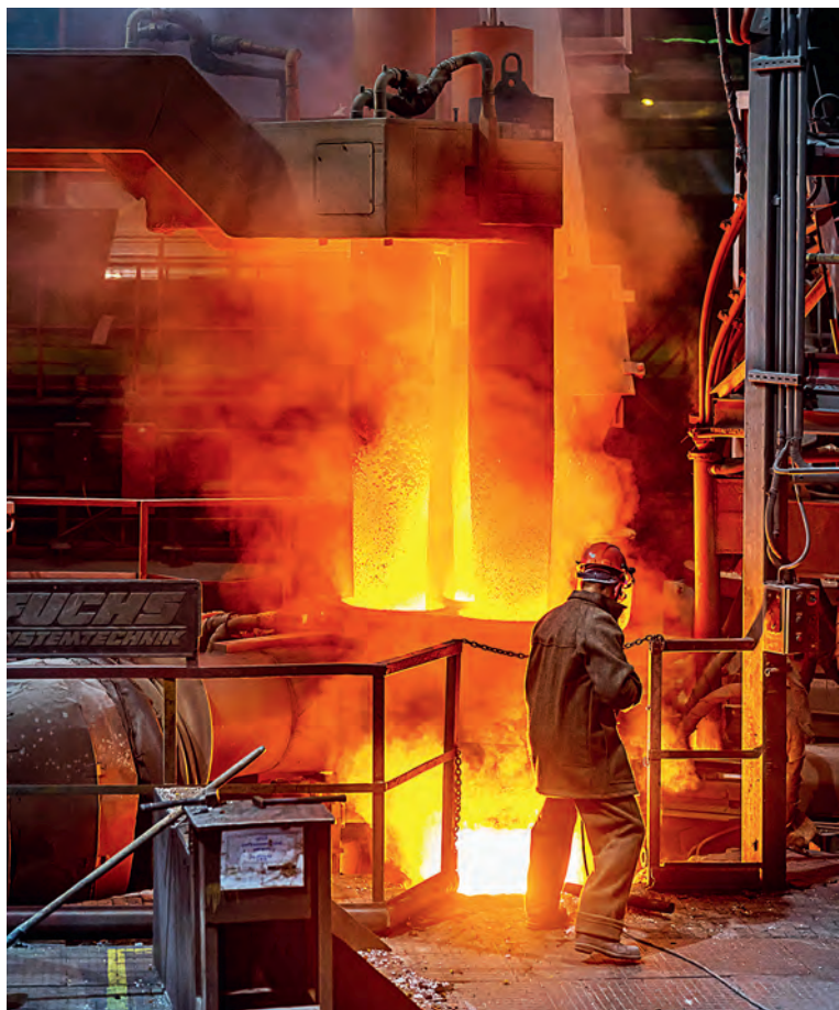
▲ Выплавка стали в оскольских электропечах с использованием железа прямого восстановления позволяет снизить нагрузку на экологию
