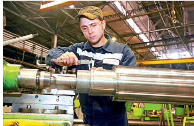
цикле производства проката. Специалисты СПЦ №1 провели анализ выявленных дефектов суппортов (узел для крепления инструмента — прим. ред.) и совместно со специалистами управления главного механика и ремонтно-механического цеха приняли решение о восстановительном ремонте узлов, влияющих на точность и стабильность работы агрегата в целом.
