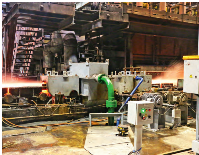
Гидросбив — наиболее эффективный метод удаления окалины.
