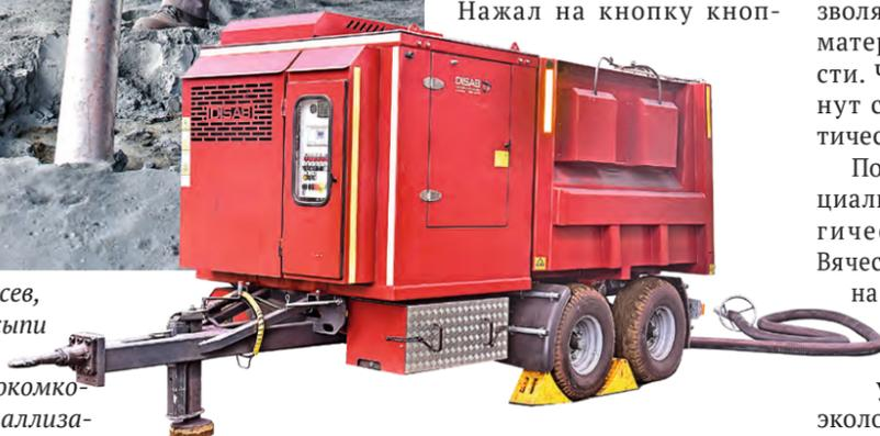
▲ Вакуумно-уборочная машина — это мобильный агрегат, установленный на шасси. Поэтому его можно перемещать в разные точки
