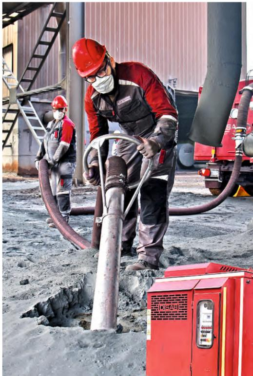
▲ Пыль, отсев, шлам и просыпи окатышей на фабрике окомкования и металлизации теперь убирают с помощью промышленного пылесоса
