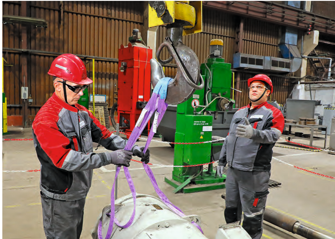
▲ Электромонтёры по ремонту электрооборудования Альберт Гончаров и Сергей Мишин ведут строповку электродвигателя на полигоне
