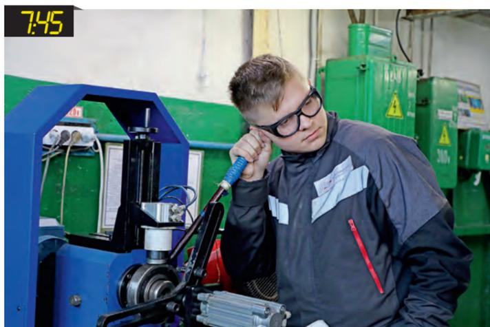
▲ 7:45. Приступаю к выполнению задач. Надо проверить подшипники электроприводов различного оборудования. Нам привозят и совсем новые, и те, что уже используются. Сначала визуально осматриваем: нет ли внешних дефектов? Измеряем геометрические параметры и сверяем их с ГОСТами. Затем при помощи специальных станков проверяем, есть ли шум и трудности при вращении этих деталей. Если отклонений нет, значит, подшипник годный. Дефектные отправляем на металлолом.
