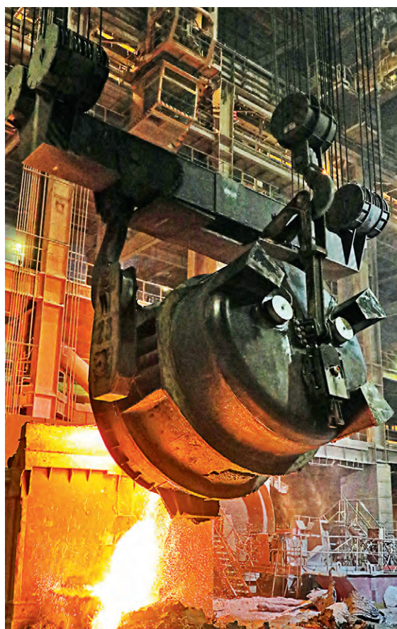
◀ Чистка сталь-ковша — тоже ювелирная работа
