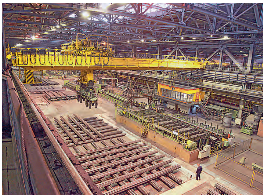
Линия правки и контроля сортопрокатного цеха №2.
