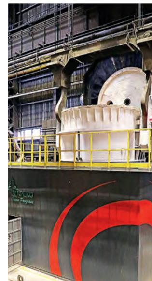
**В электросталеплавильном цехе запустили в работу новый стенд сушки футеровки стальной ковша. С помощью такого оборудования ковши готовят к дальнейшей эксплуатации.**
