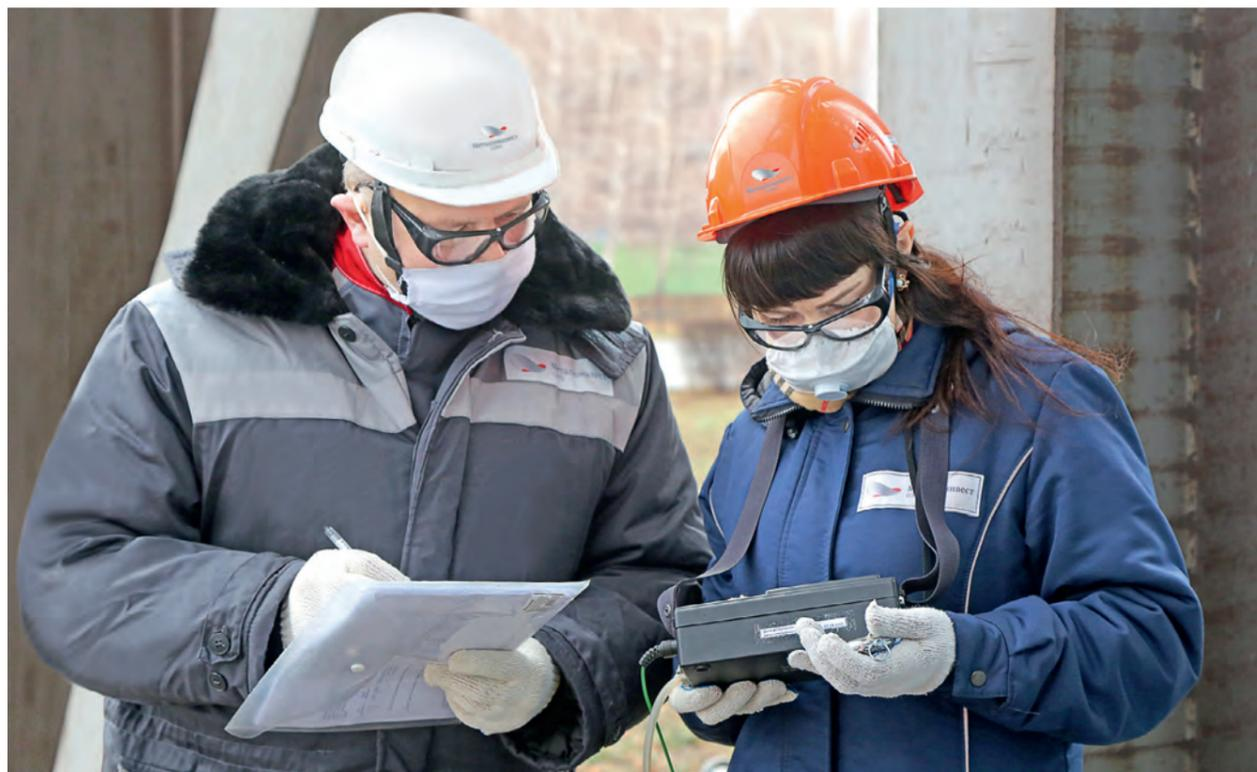
◀ Новый газоанализатор ДАГ-500 помогает определять концентрацию компонентов без применения химических методов
