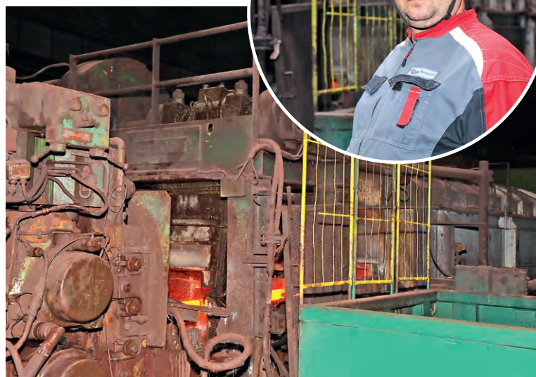
▲ Такое ограждение защищает от падения в приямок с обрезью
