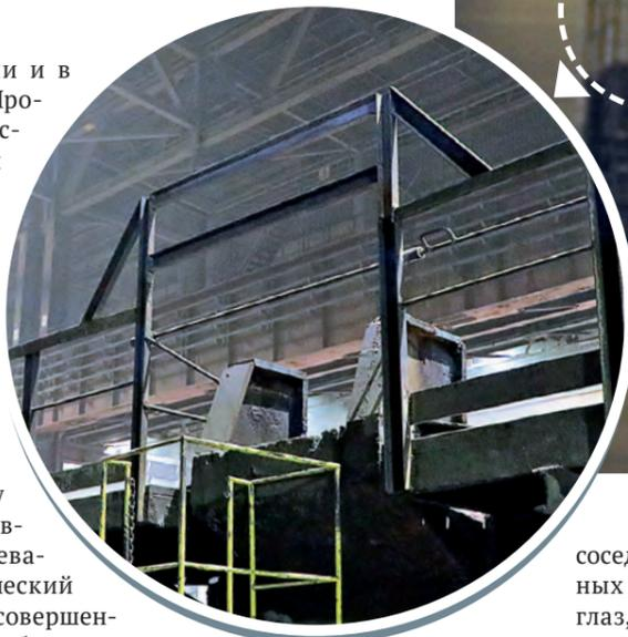
▲ В цехе выполнили проект новой выдвижной конструкции ограждения жёлоба на печи
