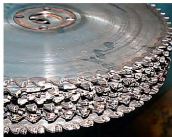
легко отпадают от зубьев пилы, и весь процесс распайки диска занимает всего около десяти минут. Таким образом, на высокочастотной установке в это время можно напаять пластины на зубья дисков пил холодной резки и при необходимости, в зависимости от загрузки цеха, увеличить её производительность практически в два раза. Сегодня идея мастера Халеева уже реализована и, по отзывам специалистов, работать стало намного удобнее.
