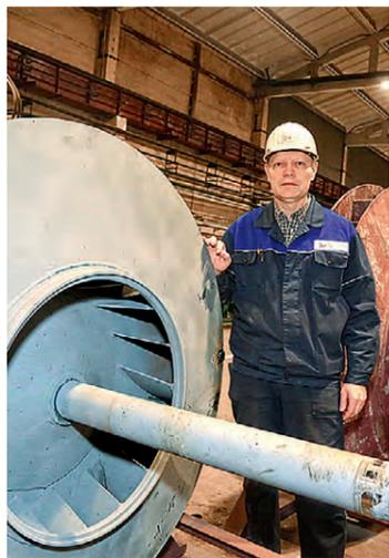
Эта деталь диаметром более полутора метров, изначально установленная на рабочем колесе, была сделана на заводе-изготовителе методом вытяжки из цельного металлического листа.
