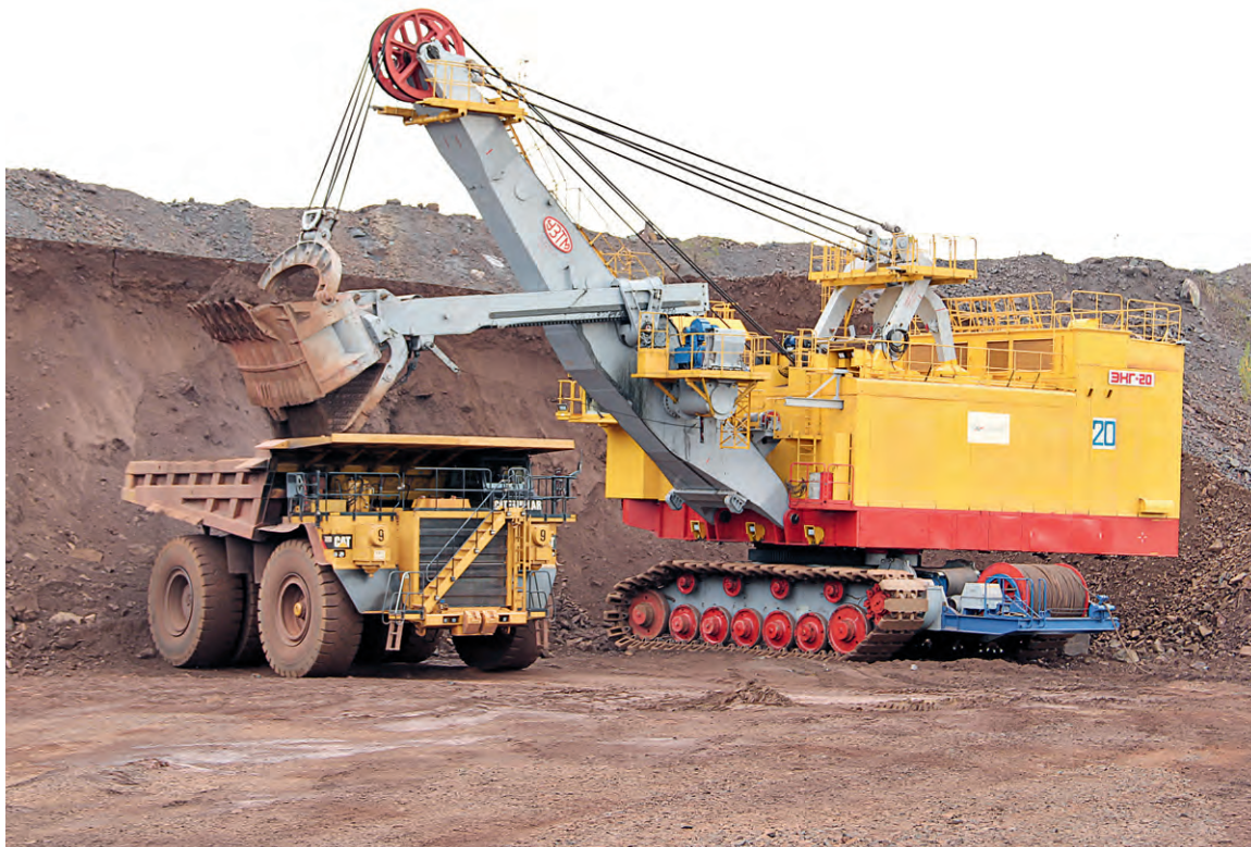
▲ Объём ковша ЭКГ-20 — 18 кубометров. Это немного больше объёма кухни в панельной хрущёвке. Масса экскаватора — порядка 750 тонн — это вес 42 пассажирских автобусов «Нефаз», доставляющих сотрудников Михайловского ГОКа на рабочие места
