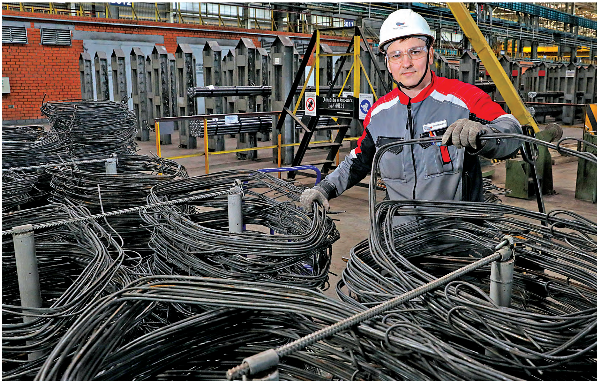
▲ Виктор Гарбуз контролирует изготовление подстроповочных хомутов из катанки диаметром 6 мм
