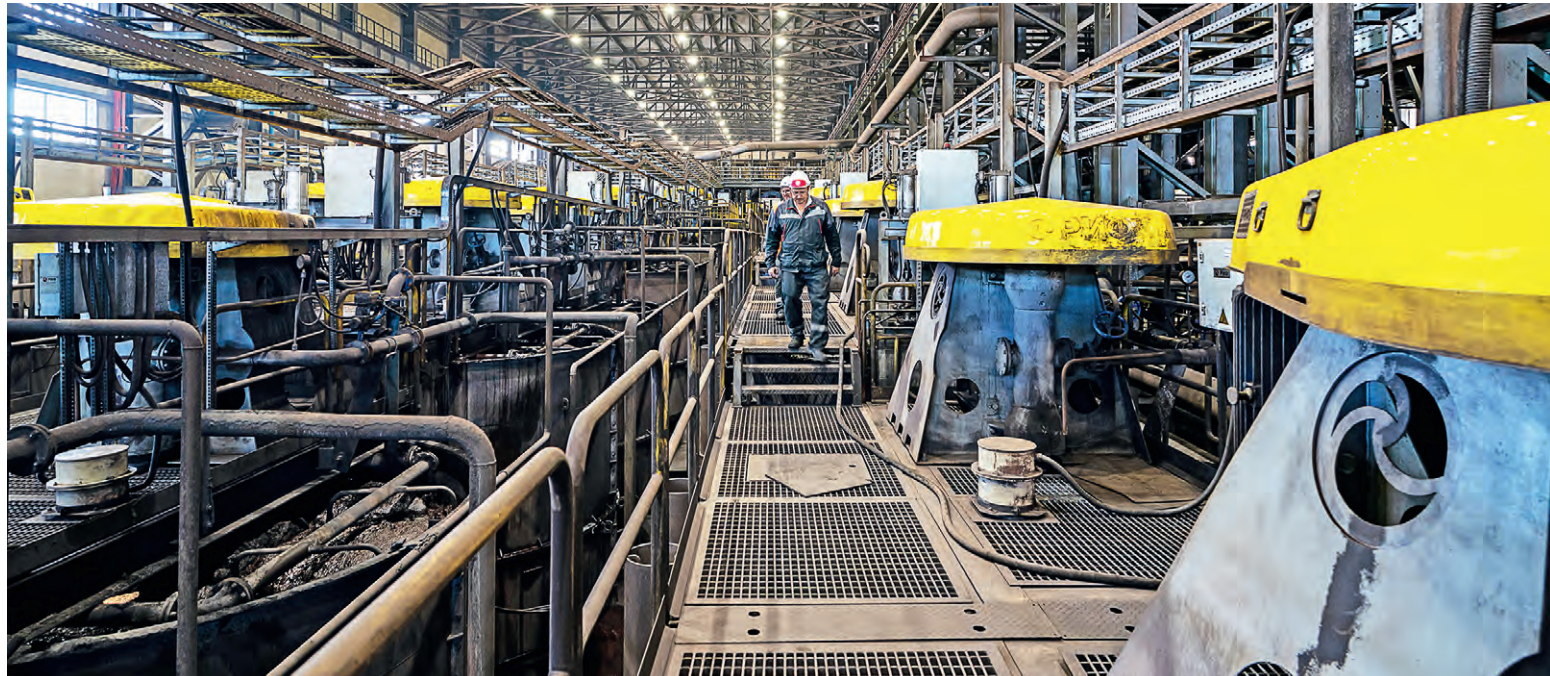
▲ Для финального обогащения концентрата на МГОКе используют флотацию
