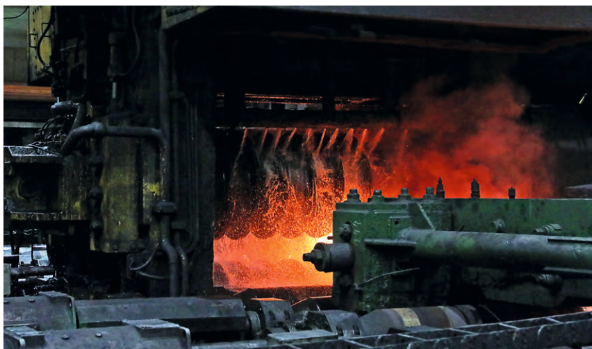
▲ Валки — основной рабочий инструмент прокатного стана
