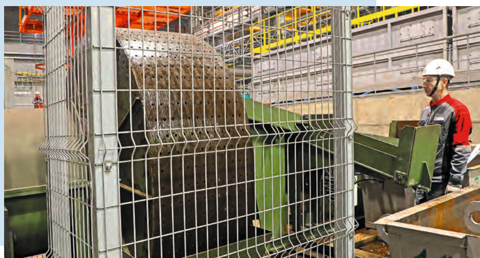
▲ Все вращающиеся механизмы и детали ограждены и не представляют опасности для сотрудников
