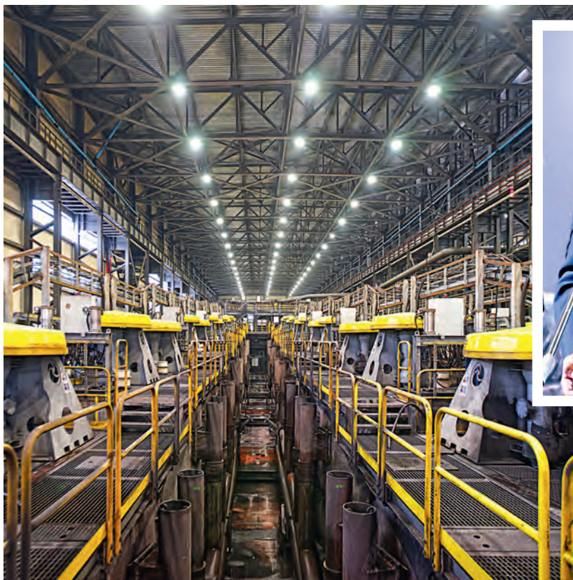
▲ Флотационное дообогащение позволяет получить концентрат самого высокого качества, содержащий 71 % железа
