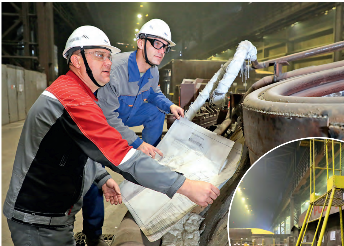
◀ Роман Щербинин и мастер по ремонту оборудования Дмитрий Балашов проверяют сборку водоохлаждаемого свода ДСП-150
