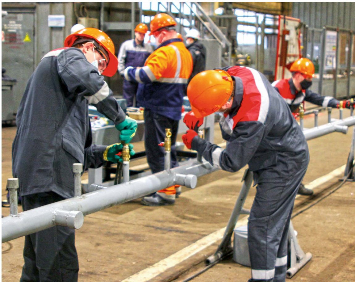
▲ Сборка водомерного узла с байпасом
