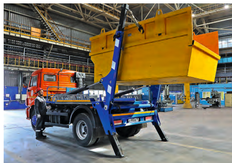
▲ Водитель контейнеровоза с помощью гидравлической системы может захватывать съёмный контейнер для загрузки и выгрузки
