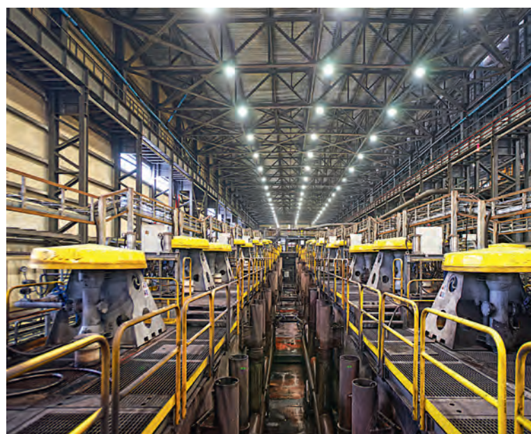
▲ Флотационное дообогащение позволяет получить концентрат самого высокого качества, содержащий 71 % железа
