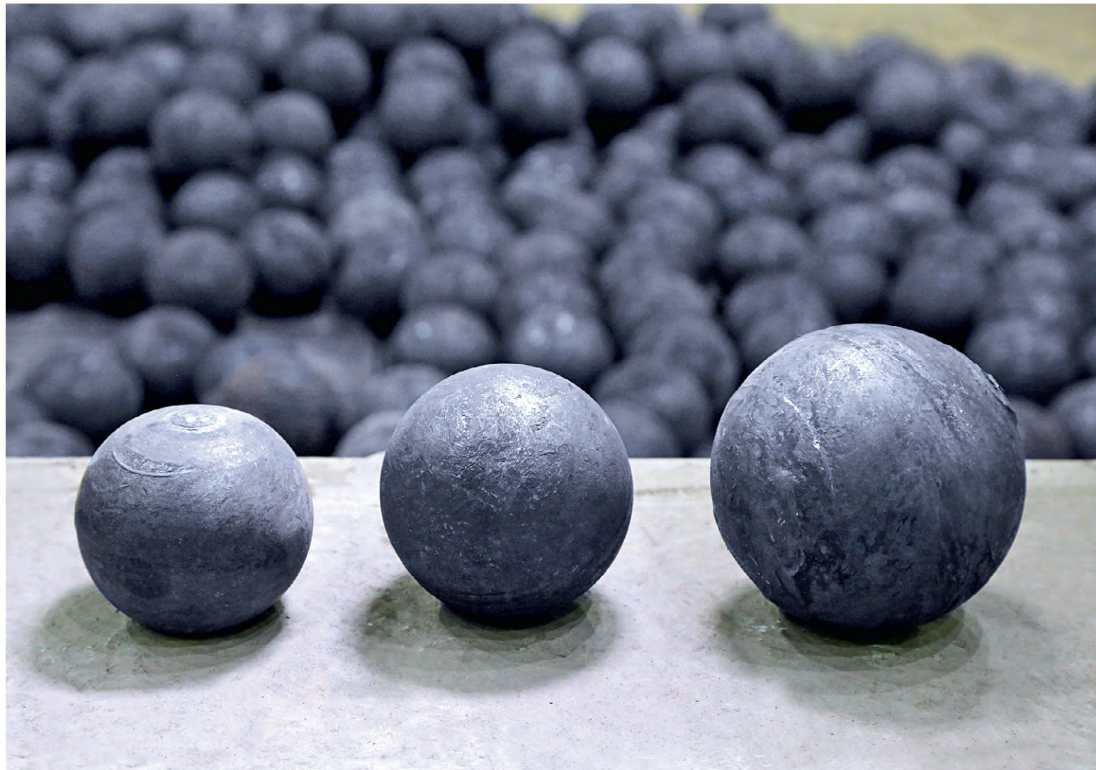
▲ Опытную партию — около 3 тонн мелющих шаров диаметром 90 миллиметров — коллектив ШПС выдал 2 июля
