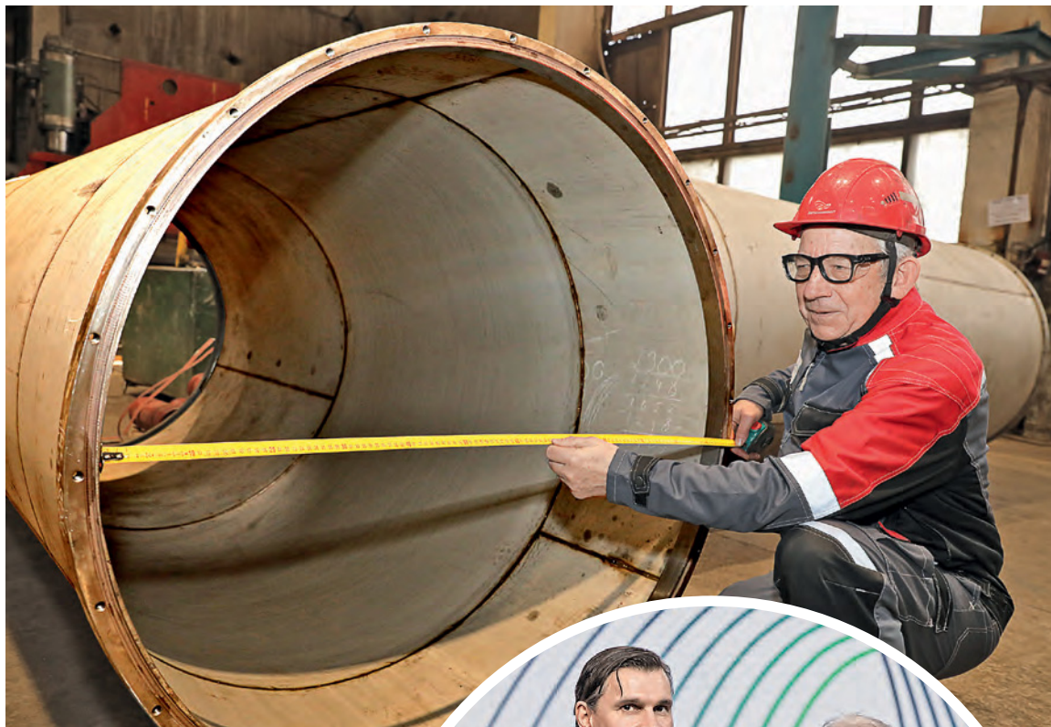
◀ Виктор Корнеев проверяет габариты свежизготовленной обечайки
