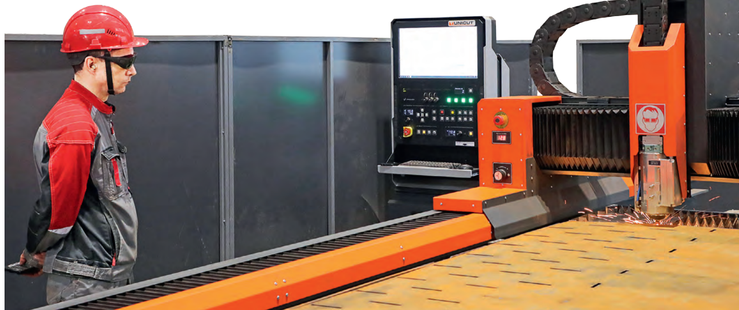
▲ Газорезчик Виталий Татаринцев делает на установке лазерной резки заготовки для корпуса обжиговой тележки ФООМ
