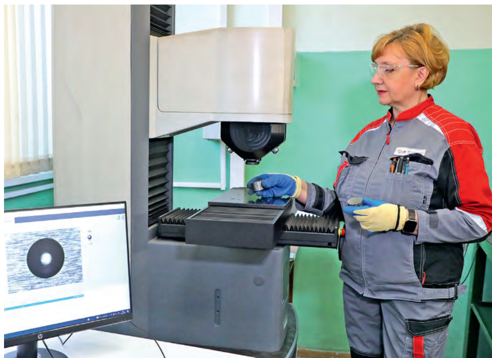
◀ Лаборант по физико-механическим испытаниям Наталья Головина определяет твёрдость на образцах проката по методу Бринелля
