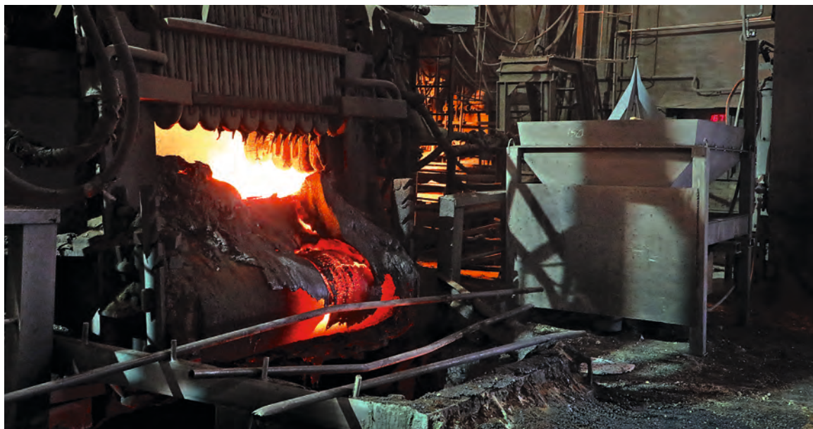
▲ Установка осаживания шлака на первой электропечи
